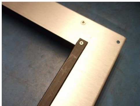
Figura 35. Installare le viti M3 da 6 mm nella striscia di usura
