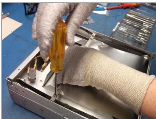
Figura 30. Stringere le viti terminali M4 da 6 mm
